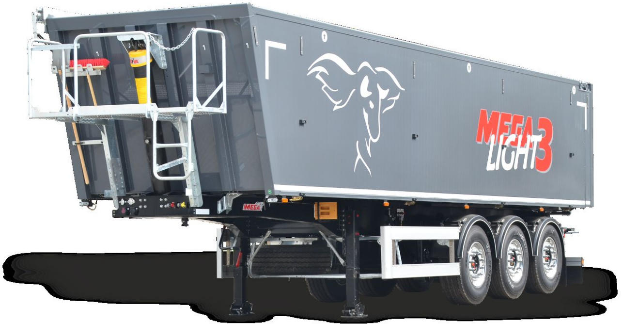
Самоскид алюмінієво-сталевий Mega Light 3-відкидні двері
